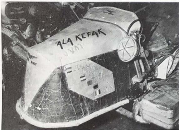
**Ecco in primo piano la parte anteriore del "corrozzino" costruito dallo stesso Minozzi utilizzando i materiali più disparati. In arabo la scritta "come tu mi vuoi". Sulla destra uno dei 4 serbatoi supplementari per il carburante.**
